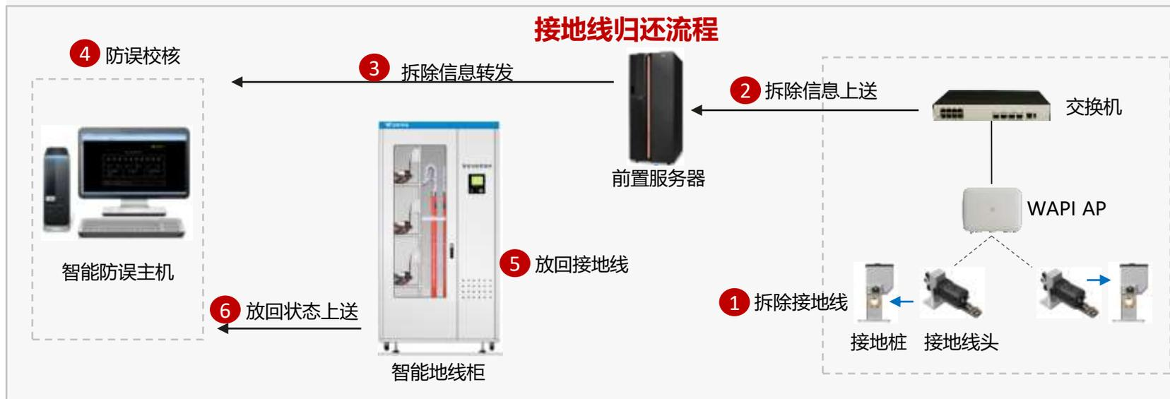
变电站接地线管理系统，通过**实时采集接地桩状态**，将原微机防误系统接地桩“虚遥信”变为“实遥信”，避免装拆接地线“走空程”操作，**杜绝接地线误挂漏拆**问题。
