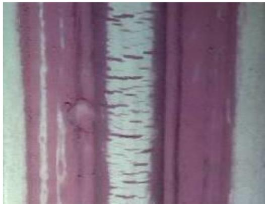
经PT检测，水冷壁母材裂纹
