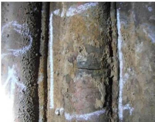
水冷壁母材裂纹
