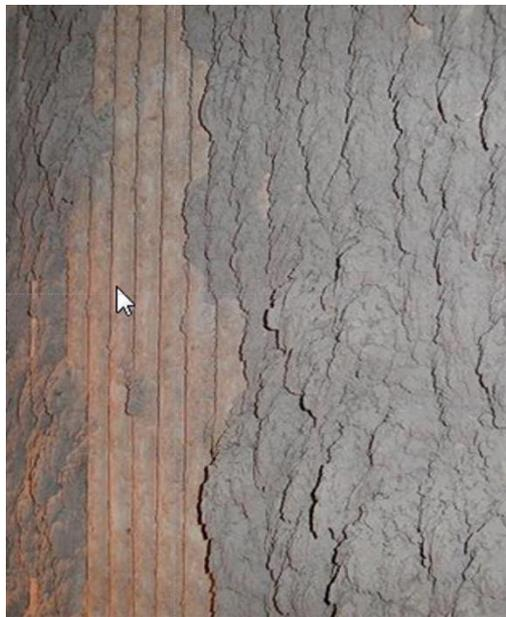
图1水冷壁结焦形貌
