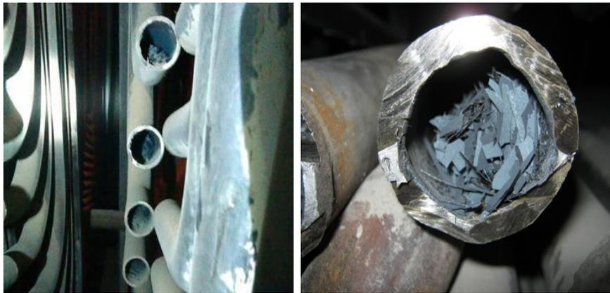
图8：高温再热器内壁氧化皮堆积
