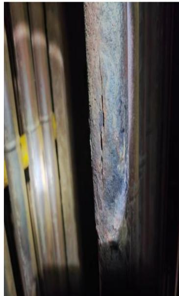
高过热器弯头腐蚀形貌
