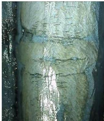
经MT检测，水冷壁焊缝及热影响区裂纹
