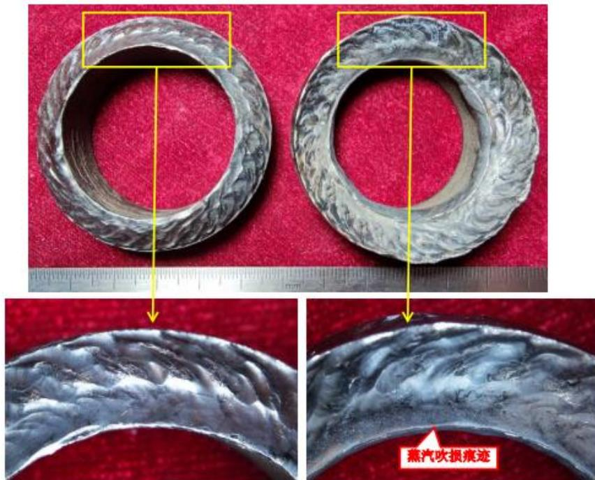
> 管样沿F91侧熔合线环向断开，断面呈灰黑色，清晰可见焊道轮廓，断面两侧未见宏观塑性变形。
