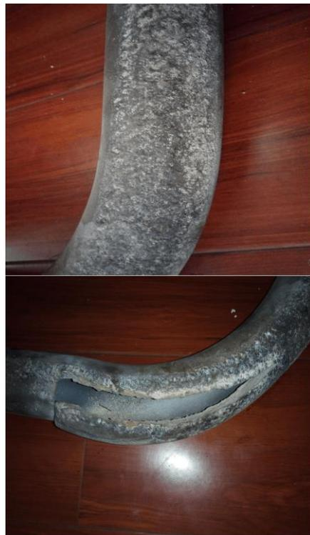
后屏过热器弯头腐蚀形貌
