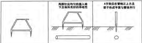
图3 电位检测装置操作示意图
