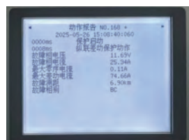
图2 110 kV 进线 1 保护装置动作报告
