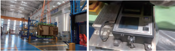
图3 器身起吊急停工况模拟
