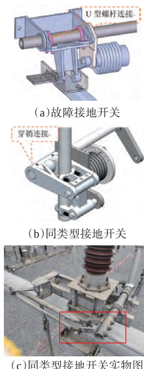
图5 不同驱动拐臂位置与驱动轴连接结构
