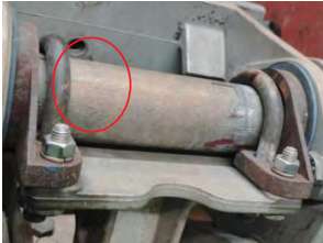
(b) 实验后传动杆表面凹槽情况
