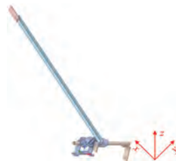
图10 接地开关及底座支撑结构
