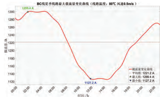
图4 夏季BC线路极限载流量日变化曲线
