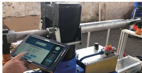
图3 耐张管自动压接
