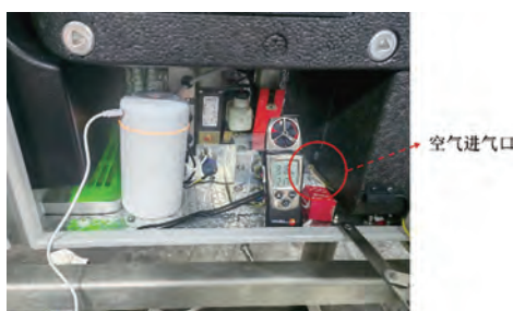
(b) 空气进气口置于箱内,箱内放置加湿器、温湿度计
