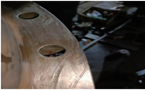
图5 轴承箱连接法兰存在拉伤
