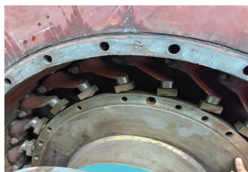
图2 轮毂内部滑块和曲柄检查
